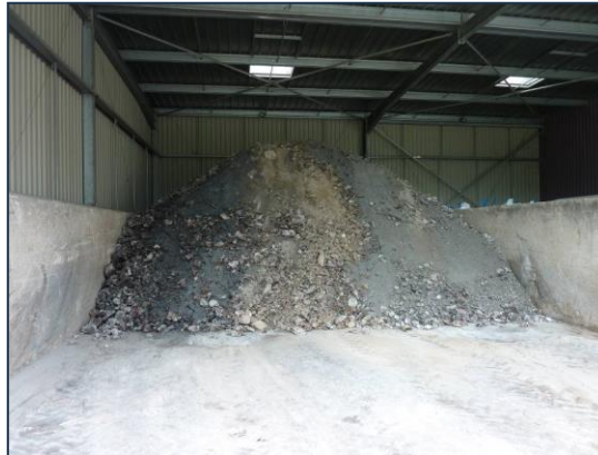
A droite: Zone de stockage des mâchefers sur une surface étanche et couverte
