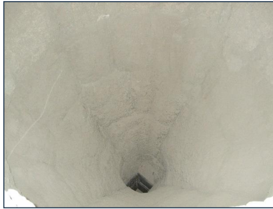
En haut à droite: Vue de l'intérieur de la chambre de post-combustion depuis le sas d'accès
